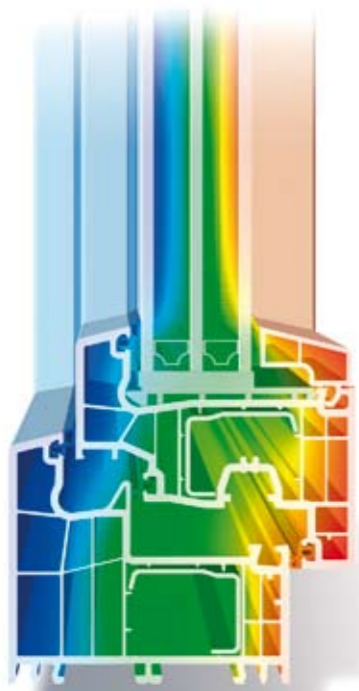
Dreidimensionale Darstellung zur Veranschaulichung von Isothermenverläufen (Isothermen: Linien gleicher Temperatur) in einem Fensterquerschnitt
